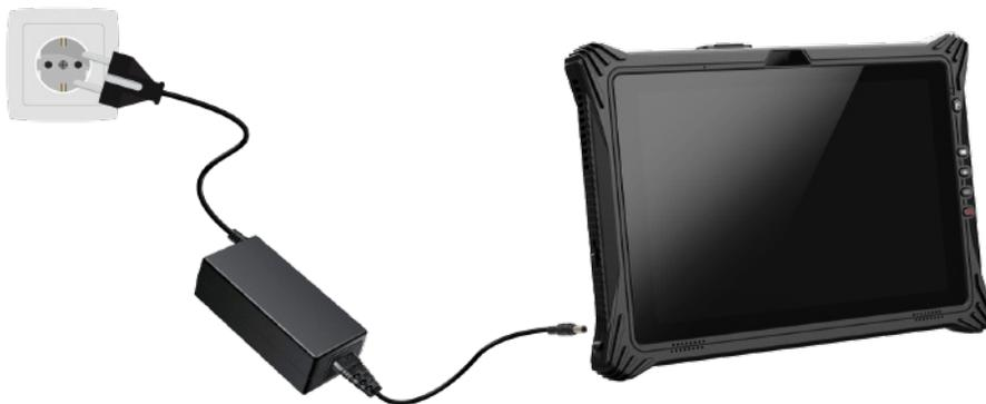
4. Питание подается из электрической розетки на сетевой адаптер и далее на планшет. Теперь можно включать планшет.
